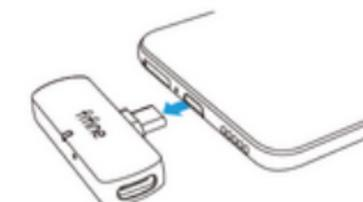
(2) Conecte el auricular en el puerto tipo-C del micrófono/receptor.
