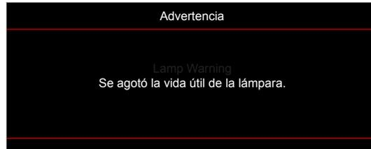
Cuando aparezca este mensaje, por favor contacte con su proveedor local o el centro de servicio para substituir la bombilla lo antes posible. Antes de substituir la bombilla, asegúrese de que apaga el proyector, desconecta el cable de alimentación y cerciórese de que el proyector se ha enfriado durante al menos 30 minutos y la bombilla se ha enfriado completamente.
