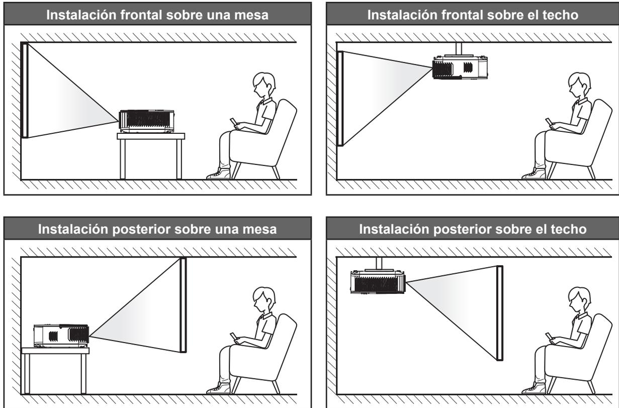
El proyector se debe colocar plano sobre una superficie y con un ángulo de 90 grados o perpendicular a la pantalla.
